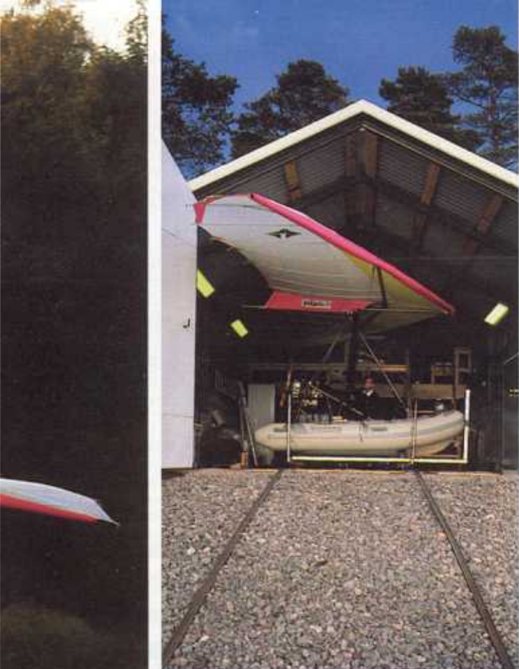
SUOMEN ainoan lentävän FIB:n omistaja on paneutunut harrastukseensa tavallista huolellisemmin. Koneelle on louhittu mökkirantaan viimeistelty halli, josta sen voi laskea sähkövinssin avulla raidekellalla veteen ja vetää lennon jälkeen takaisin halliin.
